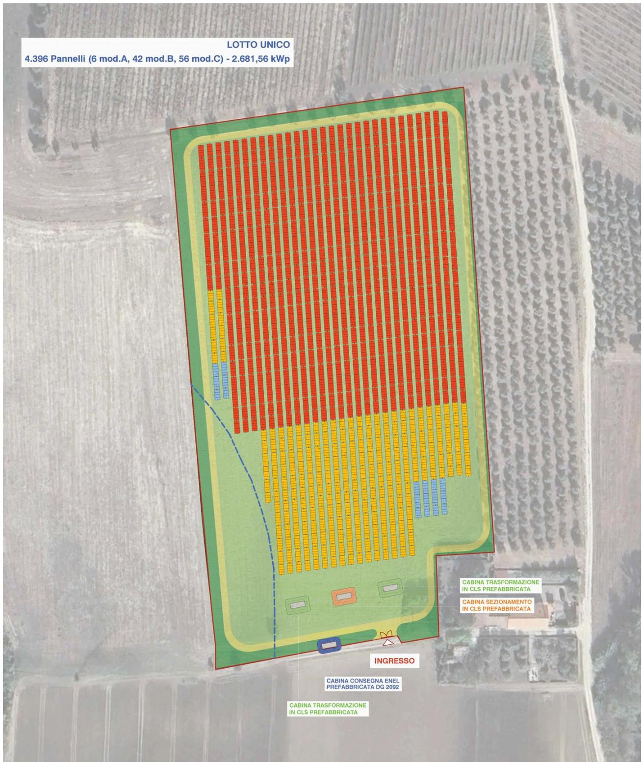
Figura 1 - Planimetria campo fotovoltaico
