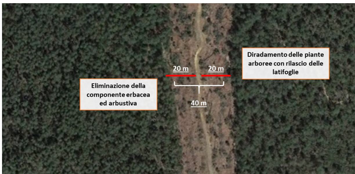
Fig. 5-2 - Viale parafuoco: esempio di viale parafuoco con fasce parafuoco di 20 m per lato
