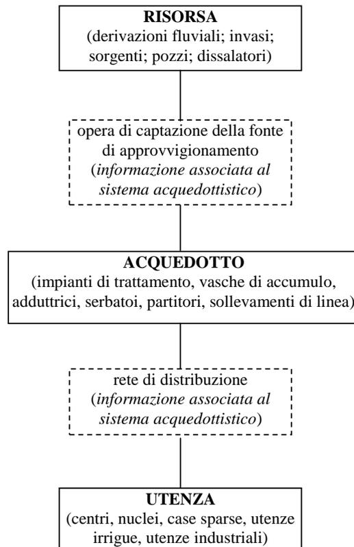
**Figura 44** Diagramma a blocchi illustrativo degli elementi del sistema di approvvigionamento
