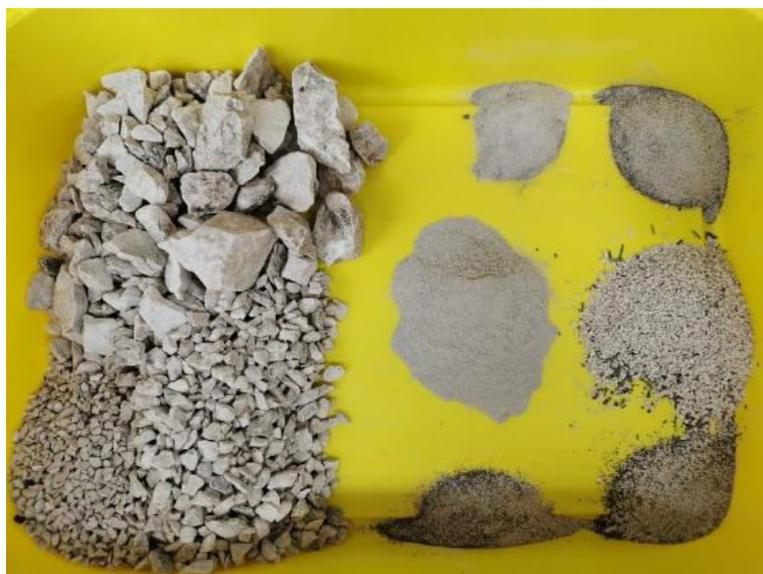
*Figura 18 – Materiale suddiviso per passanti alla fine del processo di separazione meccanica.*
