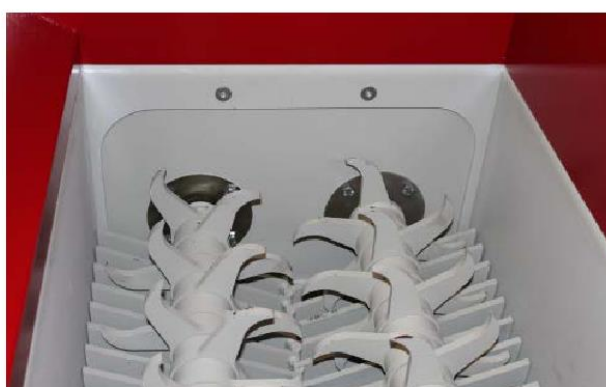
Figura 3: Particolare degli alberi a lame costituenti il frantoio
