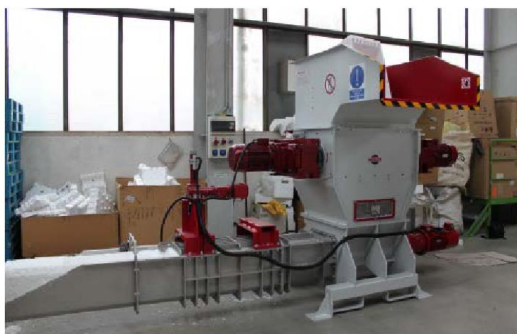
Figura 2: Vista della bocca di carico, del corpo del frantoio e del compressore
