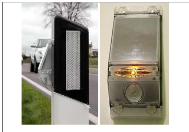
Figura 169 - Il dissuasore elettronico (acustico-visivo) utilizzato a Piacenza e Reggio Emilia. A sinistra posizionato su marginatore stradale; a destra si notano il pannello solare, il led luminoso in funzione e il microfono.
