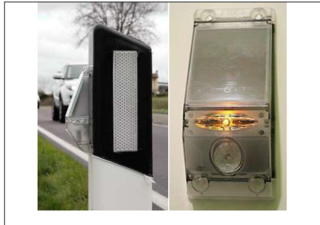
Figura 182 – Il dissuasore elettronico (acustico-visivo) utilizzato a Piacenza e Reggio Emilia. A sinistra posizionato su marginatore stradale; a destra si notano il pannello solare, il led luminoso in funzione e il microfono.
